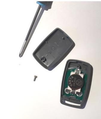
**PRENEZ GARDE** que les contacts soient au-dessus de la batterie lorsque vous la remplacez (voir les flèches ci-dessous) :
