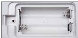
2. Insérez deux piles AA ou des piles rechargeables de 1,5 volts dans le compartiment à piles.
